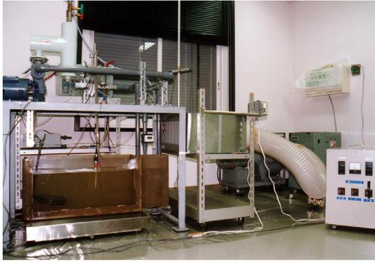
写真 5.3.1 浴槽からの蒸発量の実験<sup>3)</sup>
