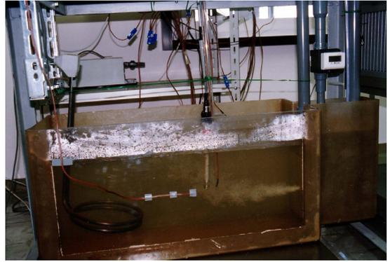
写真 5.3.2 超音波浴槽の蒸発量の実験<sup>4)</sup>
