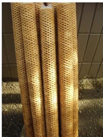
写真 5.2.1 糸巻型カートリッジフィルタ (循環ろ過で半年間使用後に交換したフィルタ)
